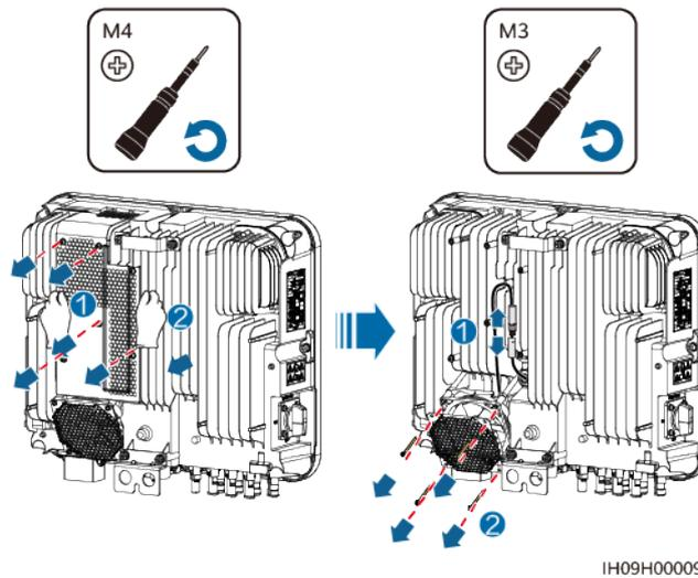
**Étape 2** Installez un nouveau ventilateur, connectez les câbles et installez le cache du ventilateur.
