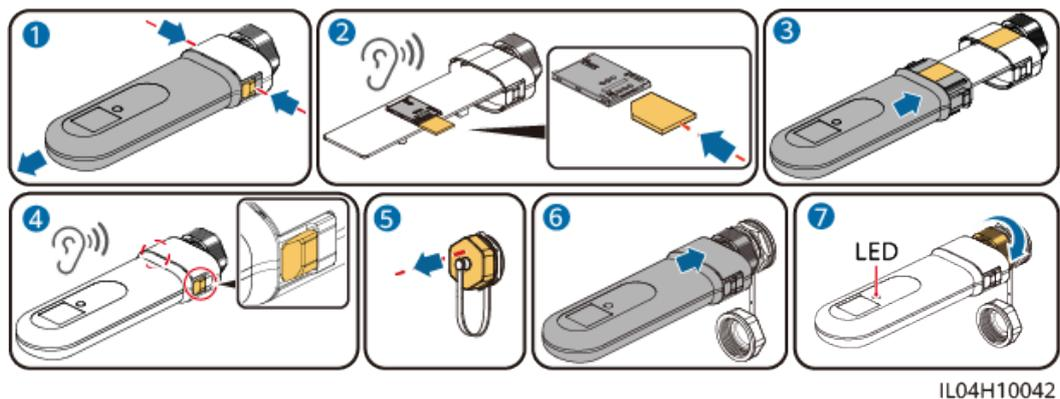
Figure 5-38 Installation des composants antivol du Smart Dongle
