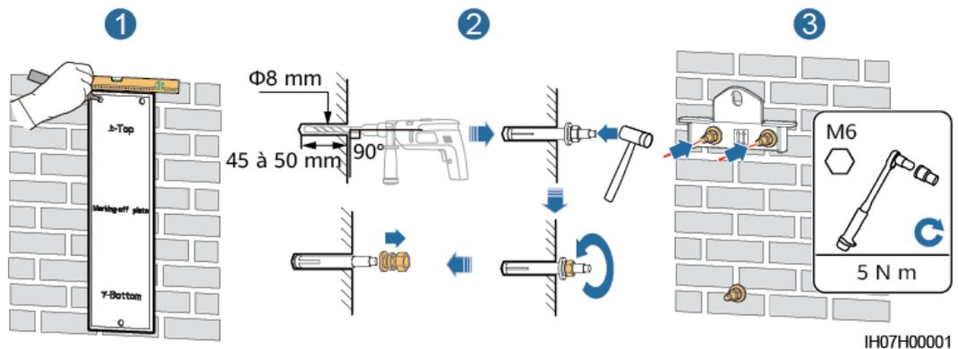
**Étape 3** Installer l'onduleur sur le support de montage.
