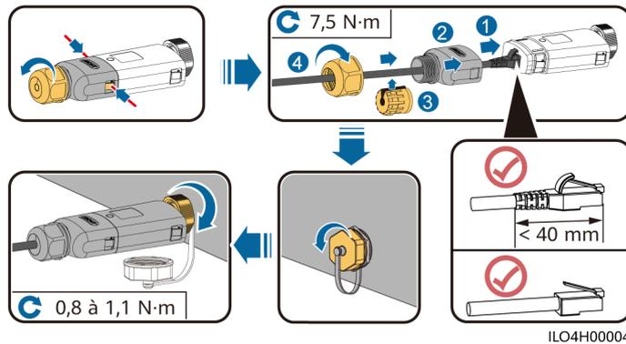
**Figure 5-36** Installation des composants antivol du Smart Dongle
